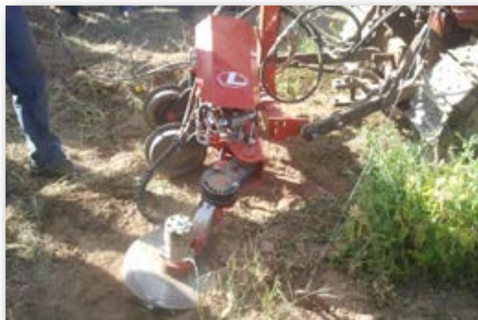
Foto 3: Fresa ad asse verticale scavalla ceppo in azione nel filare.
