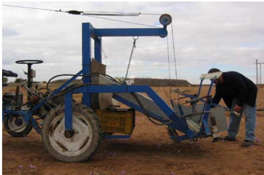
Figura 6. Macchina per la raccolta dei fiori dello zafferano
